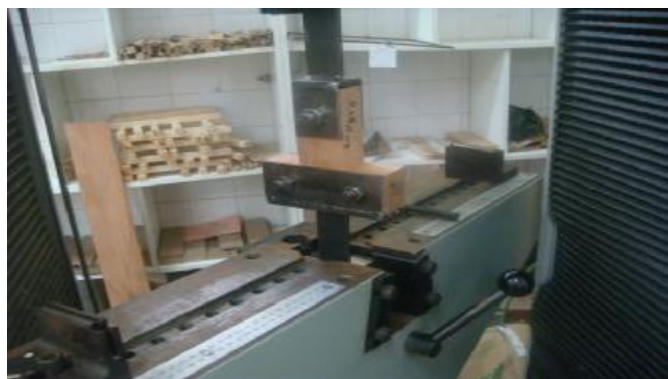
شکل 2- نمونه آزمون انفصالی در دستگاه DARTEC
