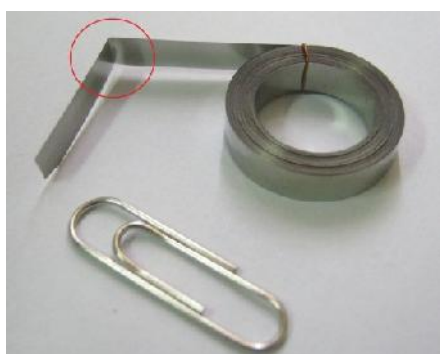
شکل ۴: فویل انجماد سریع یافته تولید شده به روش ریخته‌ریسی که به شکل حلقوی پیچیده شده است.
