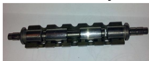
شکل (۱) - اسپول و اسلیو در نمای برش خورده از شیر
