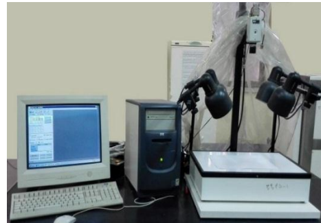
شکل ۲- دستگاه سطح سنج WinDias 2.0 مورد استفاده برای اندازه گیری سطح تصویر میوه‌ها
